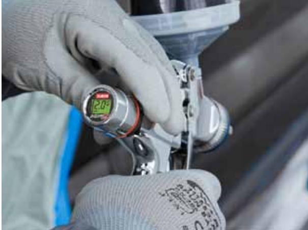
SATA adam 2 ukazuje vstupní tlak u stříkací pistole s přesností +/- 0,05 bar.
